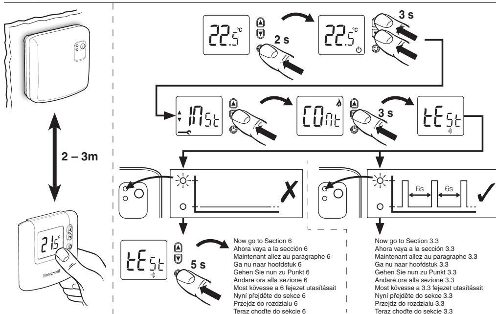
**3.3** **GB Locating the Room Thermostat** **E Ubicación del Termostato de Ambiente** **F Positionnement du thermostat d'ambiance** **NL Plaatsing van de kamerthermostaat** **D Platzierung des Raumthermostates** **I Individuazione del Termostato Ambiente** **HU Helyiség termosztát elhelyezése** **CZ Umístění pokojového termostatu** **PL Lokalizacja termostatu pomieszczeniowego** **SK Umiestenie priestorového termostatu**
