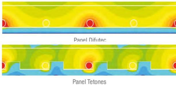
La lámina de aluminio favorece la distribución horizontal del calor y la transmisión de la energía al mortero
