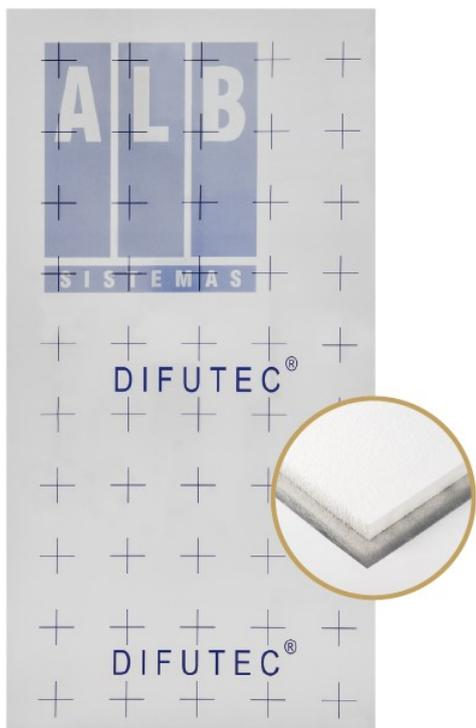
Panel aislante DIFUTEC®, fabricado en Poliéstireno expandido, autoextingible (Eurocalse E), de 10, 20, 25, 30, 45 ó 50 mm de espesor. Dispone de una lámina superficial de aluminio de 0,25mm, difusora del calor, provista de solapas autoadhesivas y cuadrícula de guía serigrafiada.
